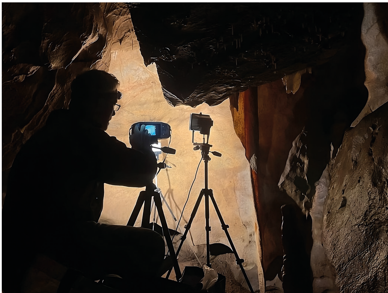
FIG. 3. — L'imageur hyperspectrale Specim IQ sur le terrain, devant le panneau principal de la grotte Mayenne-Sciences. La cible de référence se situe sous l'imageur. Crédits : photo de Romain Lahaye.
